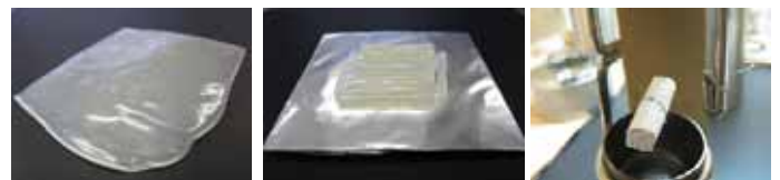
【写真1】 常温乾燥させたシート状の接着剤
